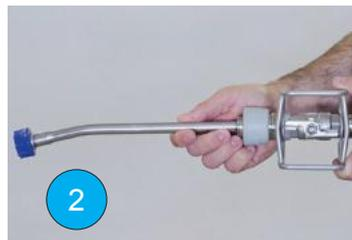
(FI) Varmista, että sinisen letkun päässä oleva palloventtiili on kiinni. Suljetussa asennossa venttiilin kahva on kohtisuoraan letkuun nähden.
