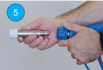
(FI) Vedä venttiilin holkkia taaksepäin. Aseta suutin. Palauta venttiilin holkki paikoilleen. Vedä suuttimesta varmistaaksesi, että se on kunnolla kiinni palloventtiilissä. Jollei ole, niin toista edelliset vaiheet uudestaan, kunnes suutin I on kunnolla kiinni palloventtiilissä.
