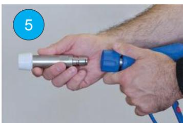
**PL** Odciągnij kołnierz zaworu. Wsuń dyszę. Zwolnij kołnierz zaworu. Pociągnij za końcówkę dyszy, aby upewnić się, że jest ona odpowiednio przymocowana do zaworu kulowego. Jeśli nie jest, powtórz poprzednie kroki do momentu odpowiedniego przytwierdzenia dyszy do zaworu kulowego.
