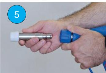
(DA) Træk ventilkoblingen tilbage. Isæt dysen. Frigør ventilkoblingen. Træk i enden af dysen for at sikre at dysen er korrekt tilsluttet til kugleventilen. Er dette ikke tilfældet gentages det foregående indtil dysen er korrekt tilsluttet kugleventilen.
