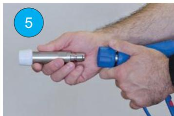
(PT) Puxe a manga da válvula. Introduza o bocal. Liberte a manga da válvula. Puxe a extremidade do bocal para garantir que está firmemente ligado à válvula de esfera. Se não estiver, repita os passos anteriores até o bocal ficar firmemente ligado à válvula de esfera.
