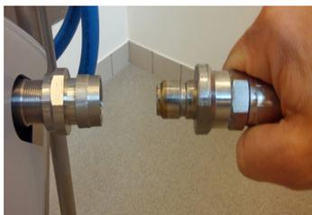
(DA) Tilslut vandforsyningslangen til tilgangsfittingen på siden af enheden. Vandforsyningsledningen skal have en lynfitting monteret for nem tilslutning til tilgangsfittingen.
