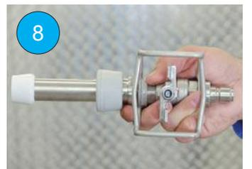
**(SR)** Da biste otvorili kuglični ventil okrenite dršku u smeru kretanja kazaljke na satu. Ventil je skroz otvoren kada je drška paralelna sa crevom.
