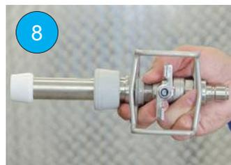
(DA) For at åbne kugleventilen drejes den forsigtigt mod uret. Ventilen er helt åben når håndtaget er parallelt med slangen.
