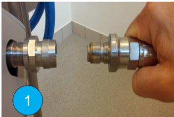
(TR) Su besleme hortumunu ünitenin yanındaki giriş bağlantısına takın. Su besleme hortumunda giriş bağlantısına kolayca takılmasını sağlayan hızlı bağlantı parçası olmalıdır.
