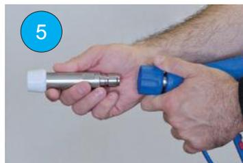
Ⓛ Potegnite nazaj manšeto ventila. Vstavite šobo. Sprostite manšeto ventila. Potegnite konec šobe, da zagotovite, da je šoba trdno pritrjena na krogelni ventil. Če ni, ponavljajte predhodni korak, dokler šoba ni trdno pritrjena na krogelni ventil.
