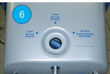
**(SR)** Okrenite prekidač birača u prednjem delu jedinice u željeni radni položaj.
