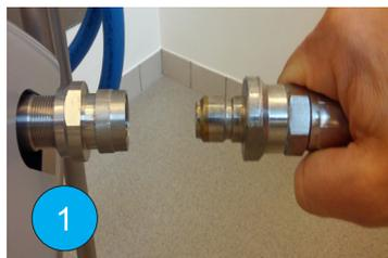
**(SR)** Povežite crevo za dostavu vode na ulazni priključak sa strane uređaja. Dovod vode trebalo bi da ima spojnicu za brzo priključivanje koja će se lako montirati na ulazni priključak.
