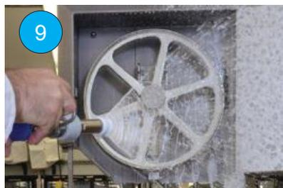
**PL** Nakładaj pianę, wodę do płukania lub środek odkażający, używając urządzenia.
