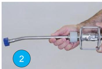
(DA) Kontroller at kugleventilen for enden af den blå forsyningslange er lukket. Ventilhåndtaget er vinkelret til slangen når den er i lukkeposition.
