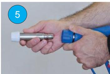
(TR) Valf yuvasını geri çekin. Püskürtücüyü takın. Valf yuvasını bırakın. Püskürtücünün ucundan çekerek püskürtücünün valf yuvasına sağlam yerleştiğinden emin olun. Yerleşmemişse, püskürtücü valf yuvasına sağlam şekilde yerleşene kadar yukarıdaki adımı tekrarlayın.
