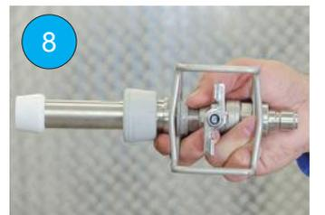
(PT) Para abrir, rode no sentido horário, a alavanca da válvula de esfera. A válvula está completamente aberta com a alavanca estiver paralela à mangueira.
