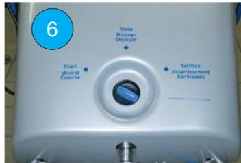
(FI) Valitse haluttu toiminto kääntämällä laitteen etuosassa olevaa valintakytkintä.
