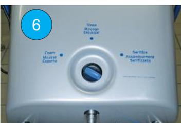
**PL** Ustaw przełącznik wybierakowy umieszczony z przodu urządzenia na wybraną czynność.
