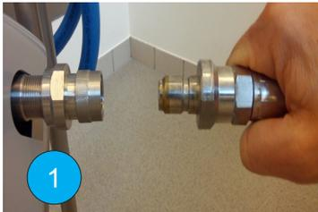
Ⓛ Povežite dovodno vodno cev z vhodnim nastavkom na strani enote. Dovodna vodna linija mora imeti nastavek s hitro spojko, ki se preprosto poveže z vhodnim nastavkom.
