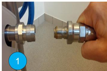
(PT) Ligue a mangueira de abastecimento de água para o encaixe de entrada no lado da unidade. A linha de abastecimento de água deve possuir um encaixe de ligação rápida que irá facilmente ligar o encaixe de entrada.
