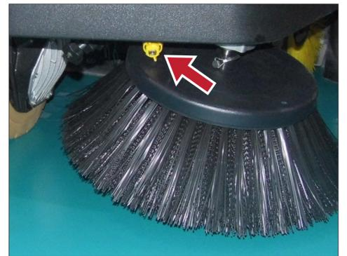
8. Если система защиты от пыли/запотевания (опция) работает неправильно, снимите фильтр сопла и очистите его.
