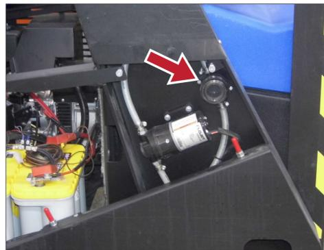
7. Если машина оснащена защитой от пыли /система запотевания, снимите правую пластиковую крышку и проверьте фильтр для воды.
