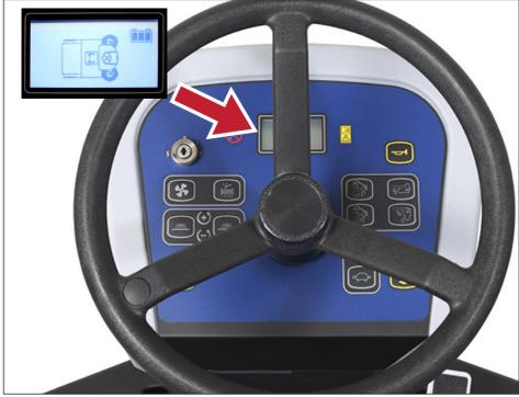
1. Проверьте уровень дизельного топлива в баке/баллоне с сжиженным газом/ уровень заряда батареи
