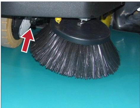
5. Проверьте высоту боковых щеток и состояние их износа. В этом случае отрегулируйте высоту, вращая ручку
