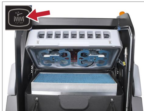
6. Перед подметанием проверьте наличие утечки пыли и, в случае необходимости, используйте шейкер фильтра для очистки основного фильтра от пыли
