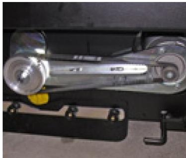
12. Проверьте натяжение основного ремня щеток и общее состояние
