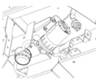
9. При наличии проверьте водяной фильтр на наличие конденсата
