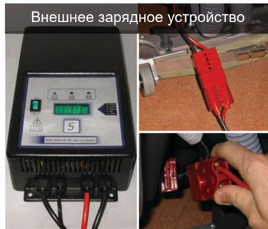
1а. Нажатием кнопки «STOP» отключить зарядное устройство. Отключить кабель зарядного устройства от красного разъёма аккумуляторной батареи. Подключить красный разъём аккумуляторной батареи к машине.
